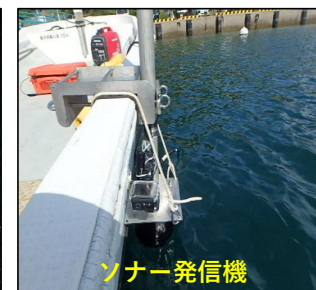
2024年6月5～6日調査実施 植生探査ソナーによる測量
